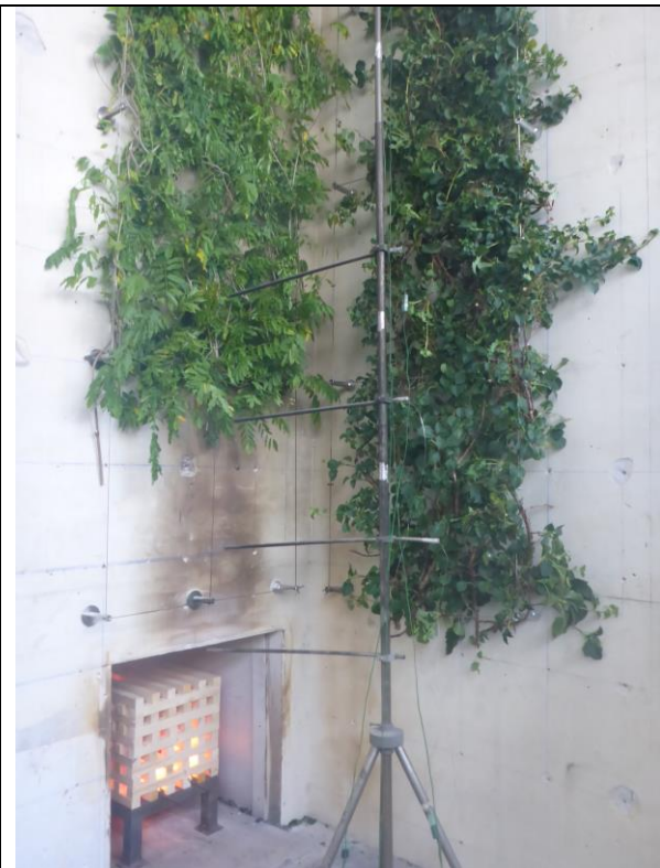
Abbildung 7-19: Fassadebegrünung unmittelbar beim Start des Versuches
