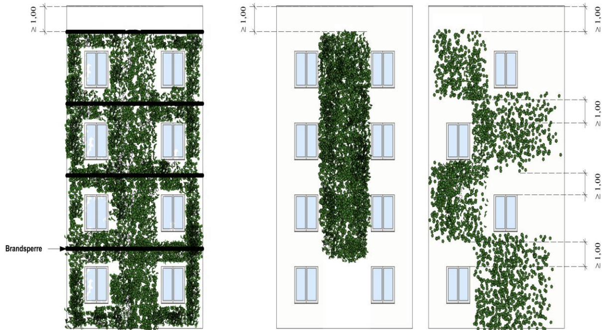
Abbildung 9-3: Systemskizzen möglicher zukünftiger Fassadenbegrünungsanordnungen an Gebäuden
