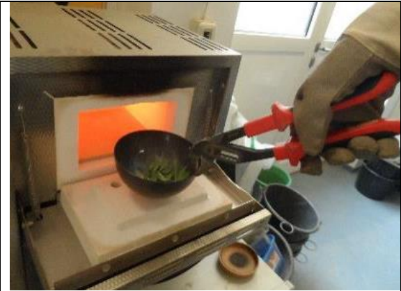
Abbildung 7-1: Einbringen von Pflanzenteilen in den Muffelofen [21]
