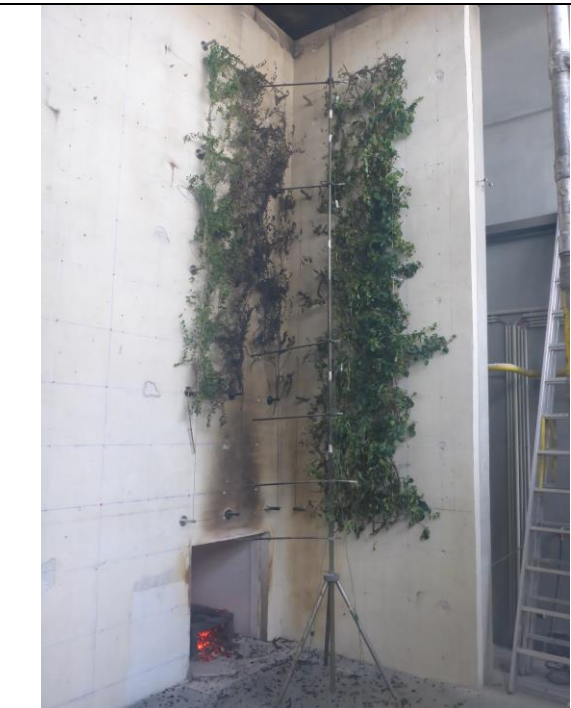
Abbildung 7-22: Fassadebegrünung nach der Prüfung
