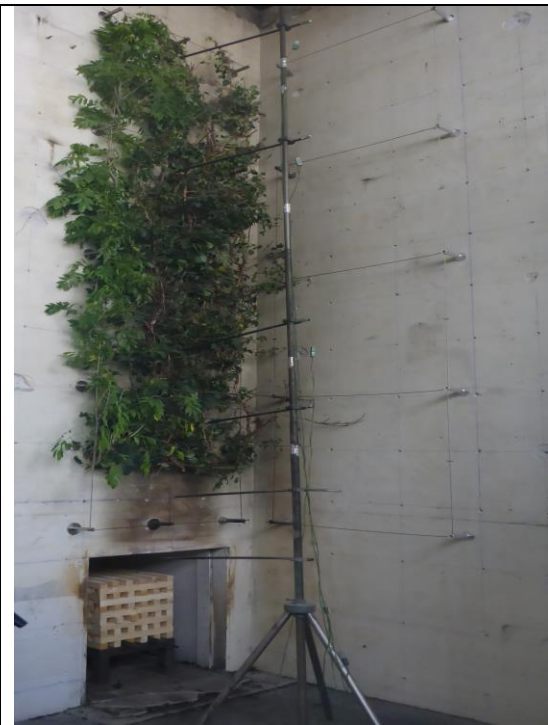
Abbildung 7-24: Grünfassade vor der Fassadenbrandprüfung
