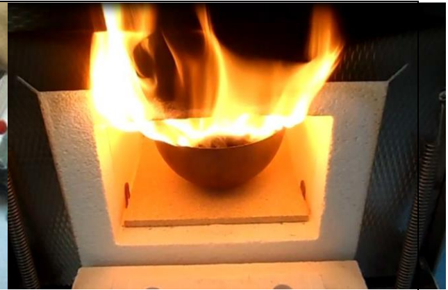
Abbildung 7-2: Mitbrand von Pflanzenteilen im Muffelofen [21]
