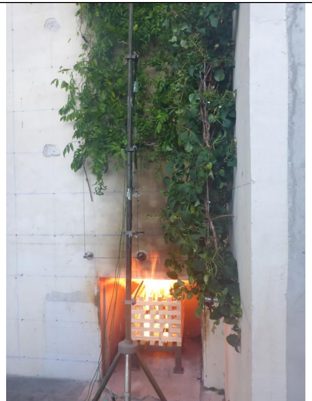
Abbildung 7-20: Probekörper nach ca. 5 Minuten Versuchsdauer
