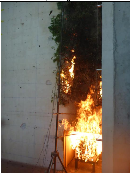
Abbildung 7-26: kurzzeitiger Durchzündungseffekt an der Grünfassade
